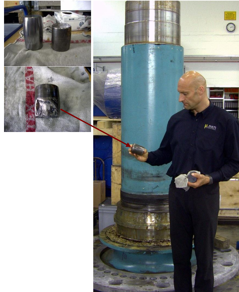
Defekter Wälzkörper eines Hauptlagers
